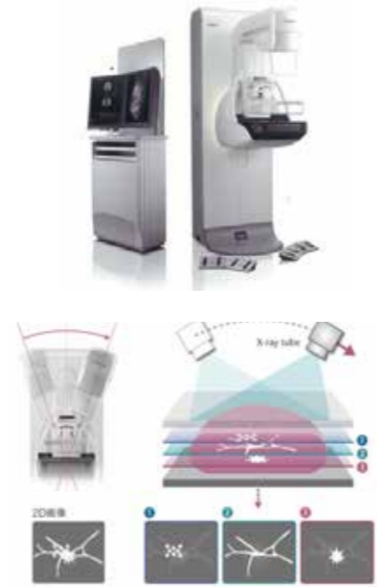
【図1】 デジタル式乳房用 X線診断装置 FDR MS_3500 X線管球が移動、低線量で照射し、複数の位置から画像を再構成。重なりによる発見困難が低減。
